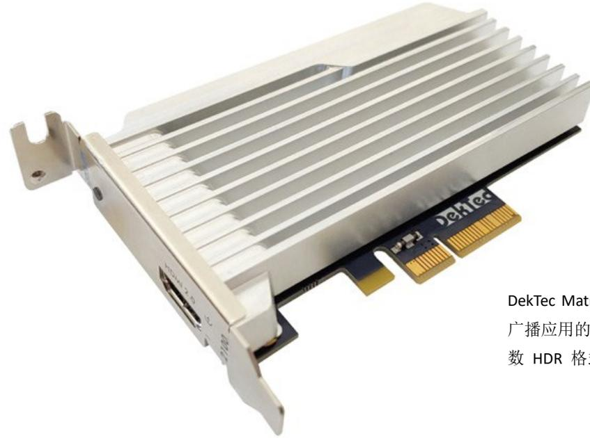
DekTec Matrix API® 2.0 完全支持用于广播应用的 HDMI 2.0b 输出渲染大多数 HDR 格式，包括杜比视界。
